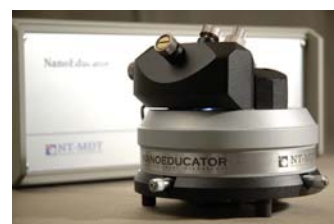
Рис. 1 – Зображення атомно-силового мікроскопу NanoEducator
