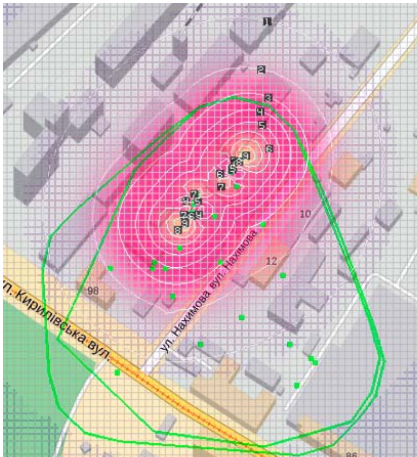
Рис. 1 – Модель розсіювання речовин у вигляді твердих суспендованих частинок та зони по часткам ГДК: 1 – 61,825 ГДК; 2 – 110,980 ГДК; 3 – 160,135 ГДК; 4 – 209,290 ГДК; 5 – 258,445 ГДК; 6 – 307,600 ГДК; 7 – 356,755 ГДК; 8 – 405,910 ГДК; 9 – 455,065 ГДК;
