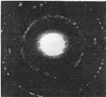
Рис. 4 – Электронограмма от поверхности трения покрытия Cr-Si-B.
