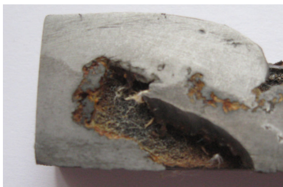
Рис. 7 – Фрагмент опытного образца из стали 35Л с наплавленным промежуточным слоем на заготовке с литейными дефектами
