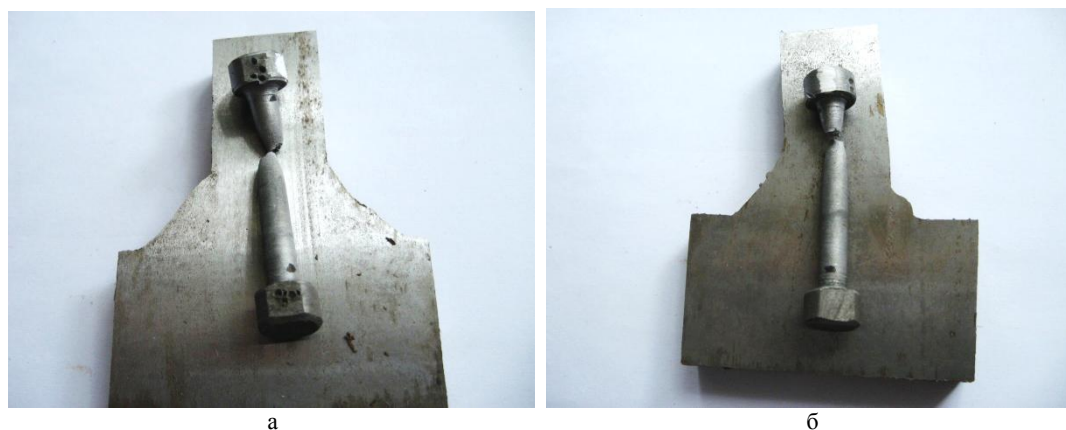
Рис. 6 – Разрушение разрывных образцов в сварных соединениях композиции 35Л-09Г2С: а – шов Т10, б – шов Т8
