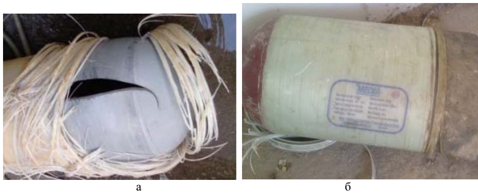
Рис. 2 – Стан поверхні сталеві оболонки балона: а - зруйновано в процесі випробувань; б - зруйновано після експлуатації на транспортному засобі впродовж тривалого періоду
