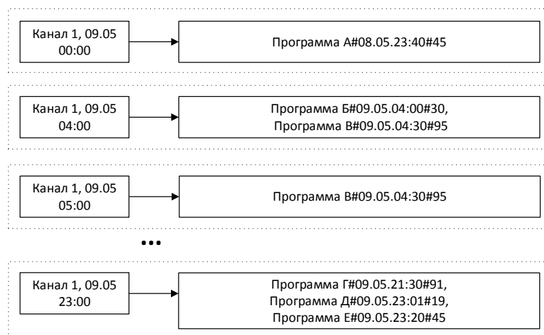
Рис. 2 – Пример синхронного индекса с объединением записей в сегменте
