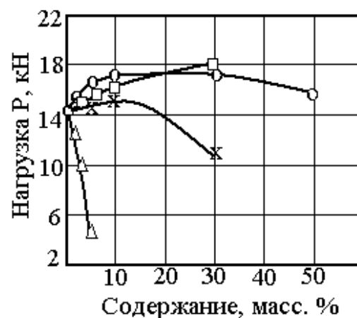
Рис. 1 – Влияние содержания различных включений на прочность при сжатии бронзы Бр010: о – X18H15; □ – Пр-ВЗК; × – ФБХ6-6-2; Δ – УДУК
