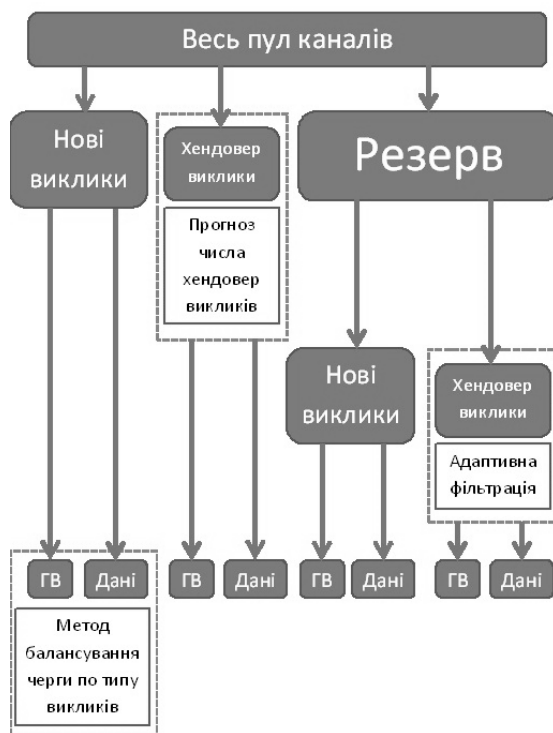
Рис. 2 – Умовна схема розподілу каналів
