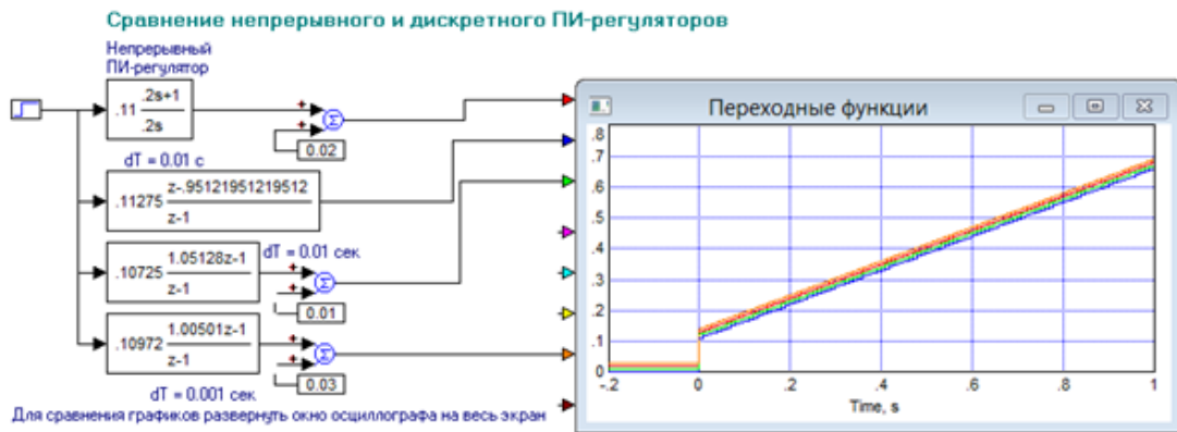
Рис. 8 – Відповідність цифрового ПІ-регулятора аналоговому
