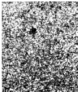
Рис. 6 – Мікроструктура сталі Р6М5 після плазмової модифікації без оплавлення з подальшим відпуском
