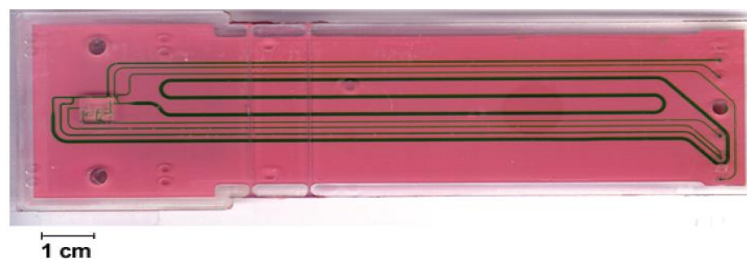
Рис. 3 – Фотографія мікрофлюїдного картриджу, що інтегровувався у прилад Biacore 3000
