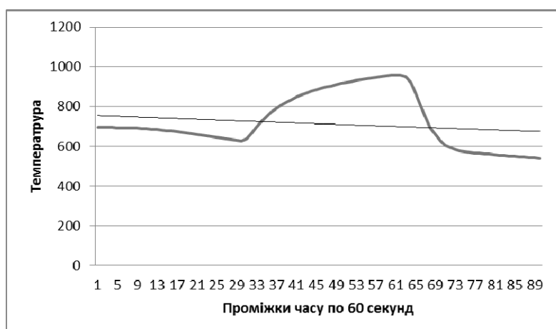
Рис. 6 – експоненціальне усереднення температури у точці Дно 2 на протязі роботи пальників із циклом переключення 30 хвилин
