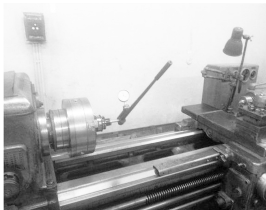
Рис. 3 – Измерение момента прокручивания M_{pr} оправки d=12 мм
