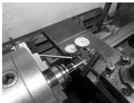
Рис. 11 – Измерения радиальной жесткости j_r оправки d=12 мм
