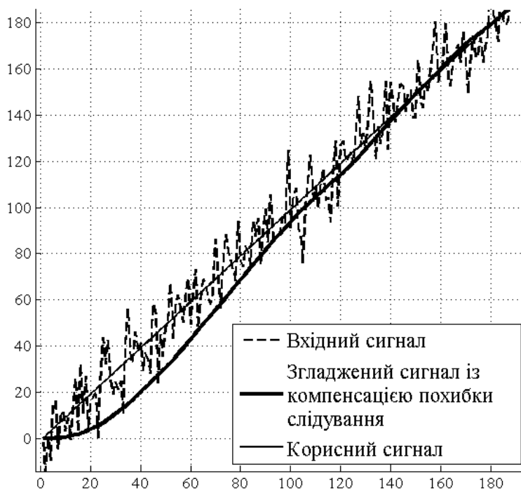
Рис. 7 – Процес прогнозу і компенсації похибки слідування
