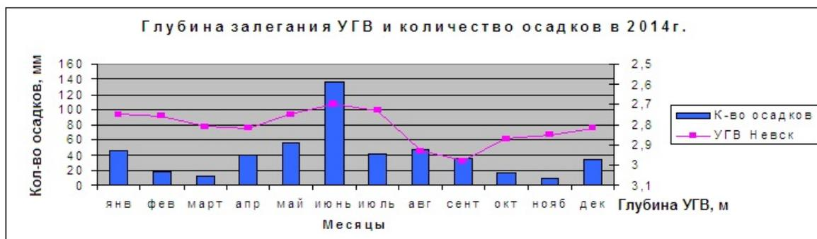
Рис. 7 – Результаты измерений глубины залегания УГВ в 2014г. в скважине по ул. Невского
