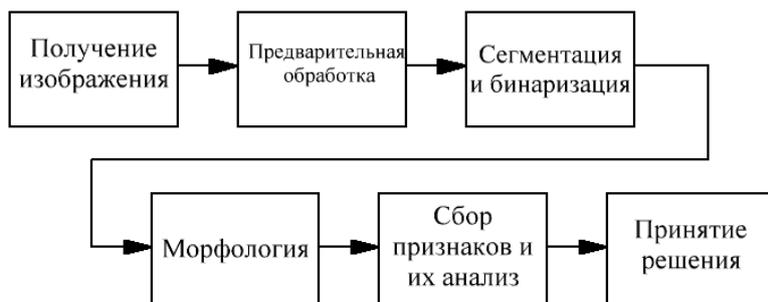
Рис. 3 – Упрощенная схема распознавания образов на изображении
