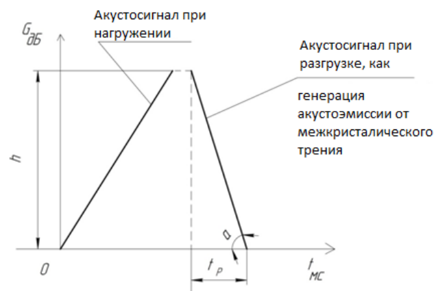
Рис. 2 – Диаграмма акустосигнала при исследовании образца
